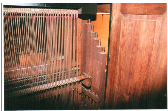
Parte do interior da caixa e mecanismo da tração mecânica
